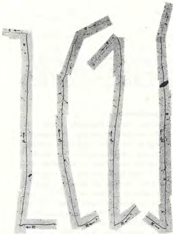
Sönderfall av \pi - och \mu -mesoner registrerade i en fotografisk plåt. Sönderfallet kan beskrivas så här
