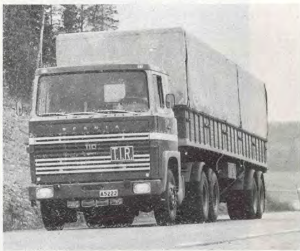
Lastbil från Scania-Vabis med sexcylindrig fyrtakts dieselmotor på 275 hk försedd med avgasdriven turbinkompressor.
