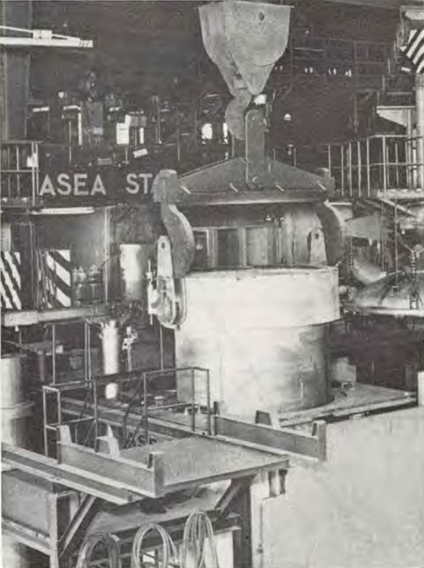
50 tons skänkguvsanläggning hos AB Bofors, Kilstaverken, för vakuumbehandling av stål enligt ASEA-SKF-metoden.
