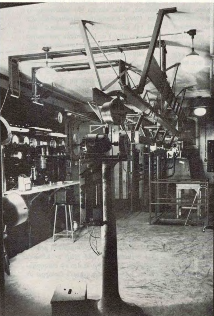
En av The Svedbergs ultracentrifuger från 1930-talet.
