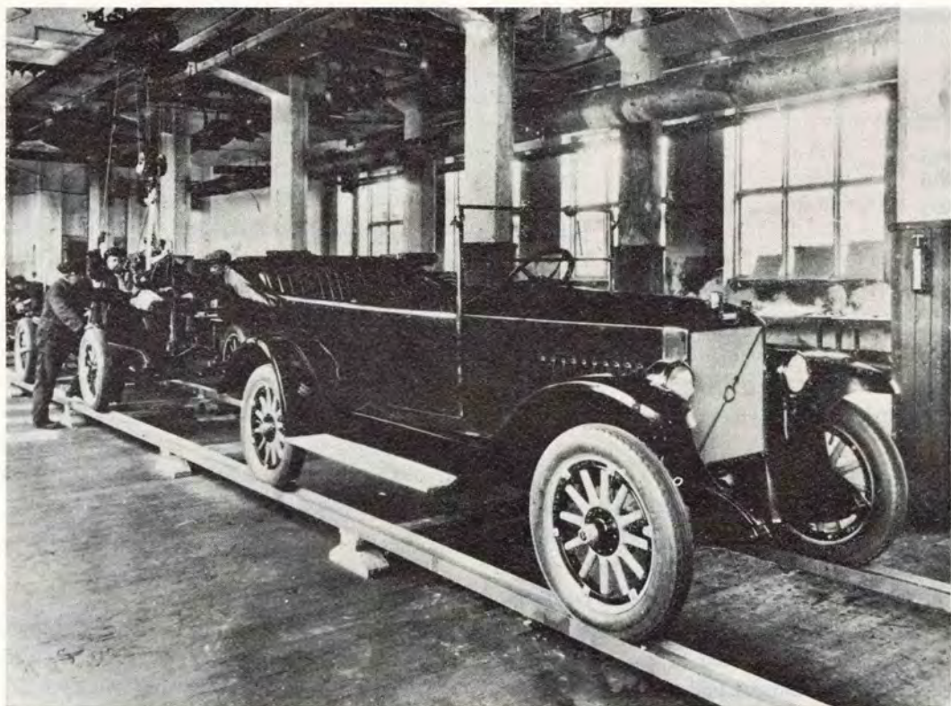
Den första helsvenska serietillverkade personbilen lämnade Volvos monteringslinje den 14 april 1927. Modellen, som gjordes i 205 exemplar, var treväxlad och drevs av en fyrcylindrig motor på 28 hk.
