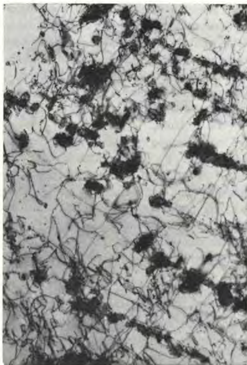
Mikrostrukturen hos ett rostfritt stål, deformerat genom belastning vid 600° C (krypning). Provstaven 1 cm i diameter har belastats med 180 MN/m 2 (18 kp/mm 2 ) under ca 4 månader. (Motsvarar en personbil, hängande i provstaven.) De mörka partiklarna är karbider, som utskilts i stålet. »Trådarna» är sk dislokationer, som bl a bildats vid provets belastning. Uppkomsten, tillväxten och rörelsen hos dislokationer och utskiljningar hör till de fenomen man speciellt önskar studera med HV-mikroskopi. Bilden är tagen med KTH:s materialcentrums HV-mikroskop hösten 1969 och ingår i en pågående undersökning vid Institutet för Metallforskning. Spänning 1 000 kV, förstoring 29 000 ggr. Bild från Institutet för Metallforskning. Foto: S Karlsson.
