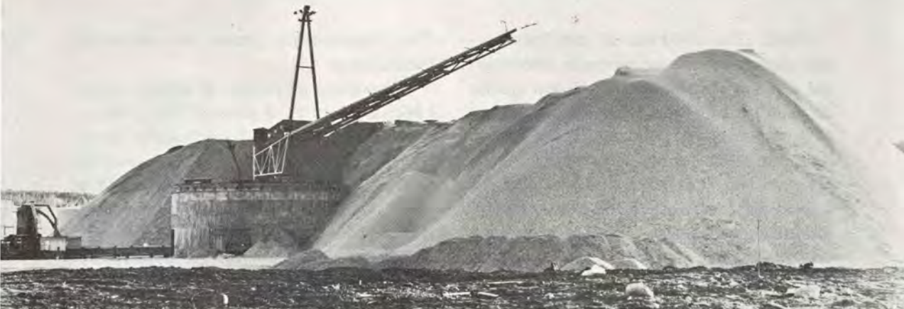
Vid cellulosafabrikerna lagras numera råvaran i form av flis i stället för som hela stockar. Genom kontinuerlig tillförsel och uttag från en ringformig hög, såsom här vid Domsjö Sulfütfabrik, enligt Jerfveds Mekaniska Verkstads system, erhålls en jämn uppehållstid och en enhetlig råvara i fabriken.
