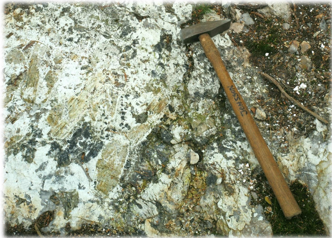
Stora kristaller av litium-aluminiumsilikatet spodumen , världens viktigaste malmmineral för litiumproduktion, från nyupptäckta Li-pegmatitfältet i Bergby, Gävleborg
